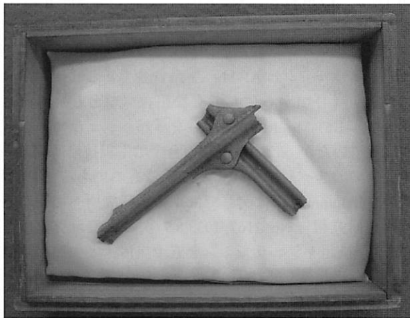
図6 ツェッペリン飛行船の骨材の残材 10)
